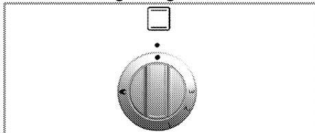
Le grill est activé avec la manette de contrôle du grill. En position Arrêt (indicateur vers le haut), il n'y a pas d'alimentation en gaz.
