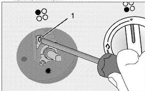
5. Réglez la hauteur de la flamme sur 2 à 3 mm à l'aide de la vis 1 sur le thermostat du four. Tourner la vis dans le sens des aiguilles d'une montre réduit la flamme, dans le sens inverse des aiguilles d'une montre augmente la flamme.
