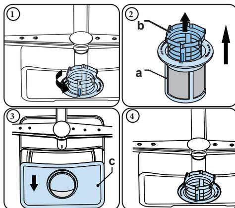
Pour enlever et nettoyer la combinaison du filtre, tournez cette dernière dans le sens inverse des aiguilles d'une montre et retirez-la en la soulevant (1). Retirez le gros filtre du micro filtre (2). Tirez le filtre métallique, puis retirez-le (3). Rincez le filtre en utilisant beaucoup d'eau jusqu'à ce qu'il n'y ait plus de résidus. Remettez les filtres ensemble. Replacez l'insert du filtre, et faites-le pivoter dans le sens des aiguilles d'une montre (4).
