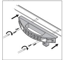
Retirez le couvercle de la poignée du sachet en plastique. Pour éviter d'installer le couvercle de la poignée à l'envers, vérifiez la direction du couvercle avant l'installation.
