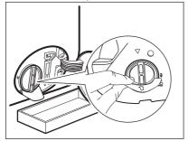
Tournez le filtre à 180 degrés vers la gauche pour l'ouvrir, sans le retirer. Laissez l'eau s'écouler.
