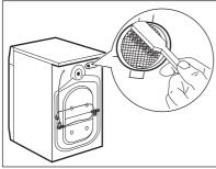
Nettoyez le filtre de la vanne à l'aide d'une brosse dure ou d'un chiffon.
