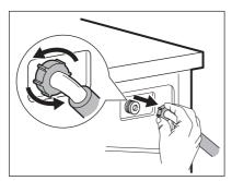
Débranchez le tuyau d'arrivée d'eau situé à l'arrière de l'appareil.
